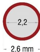
Caratteristiche filo rete in acciaio zincato rivestito in pvc
