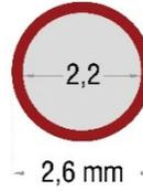
Caratteristiche filo rete in acciaio zincato rivestito in pvc
