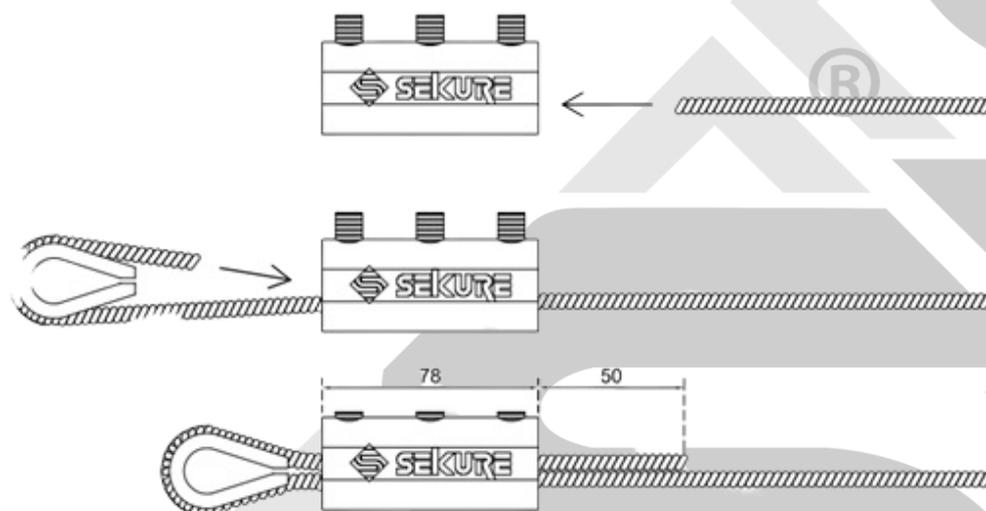
**INSTALLAZIONE:** Inserire la fune d'acciaio Ø8 nel tubo della forcella; l'operazione va eseguita dopo aver verificato la lunghezza della fune in modo che non sia troppo lunga, non riuscendo quindi ad apporre una corretta tensionatura.
